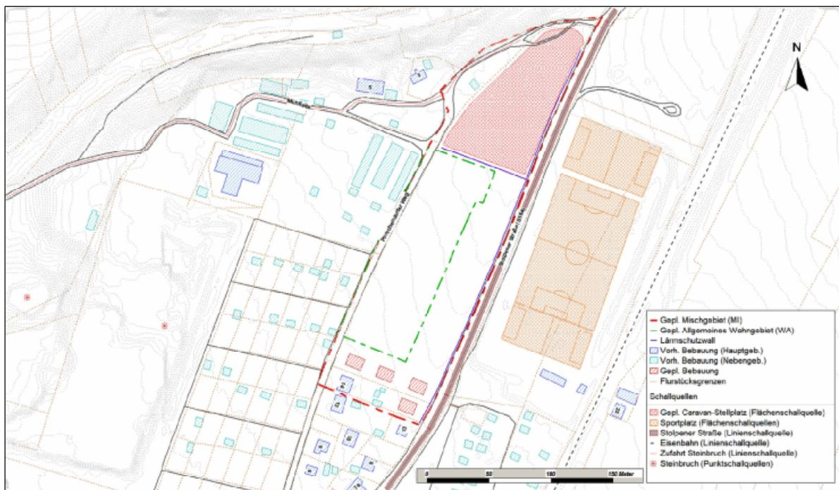
Abbildung 3: Lageplan des Rechenmodells mit Bebauung und Schallquellen, Variante 1 (mit Caravan-Stellplatz)
