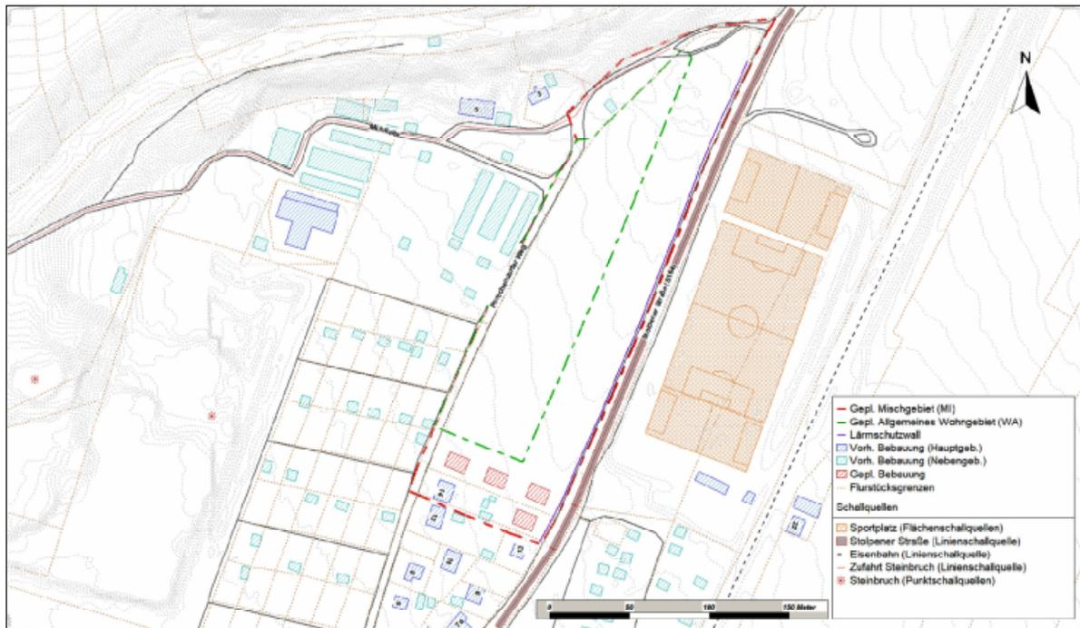
Abbildung 4: Lageplan des Rechenmodells mit Bebauung und Schallquellen, Variante 2 (ohne Caravan-Stellplatz)
