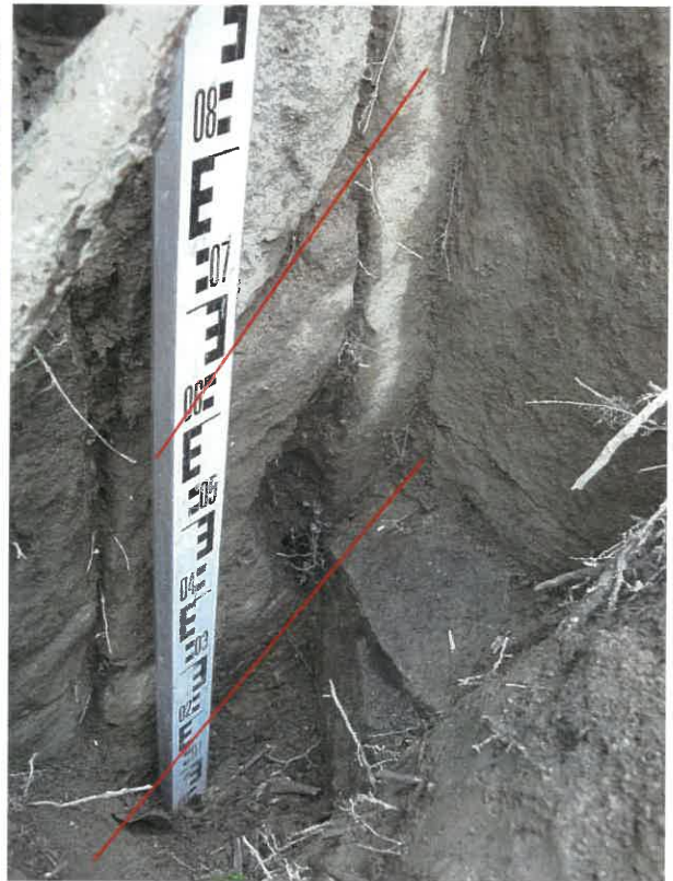
Bild 10: Offene Vertikalkluft mittig
