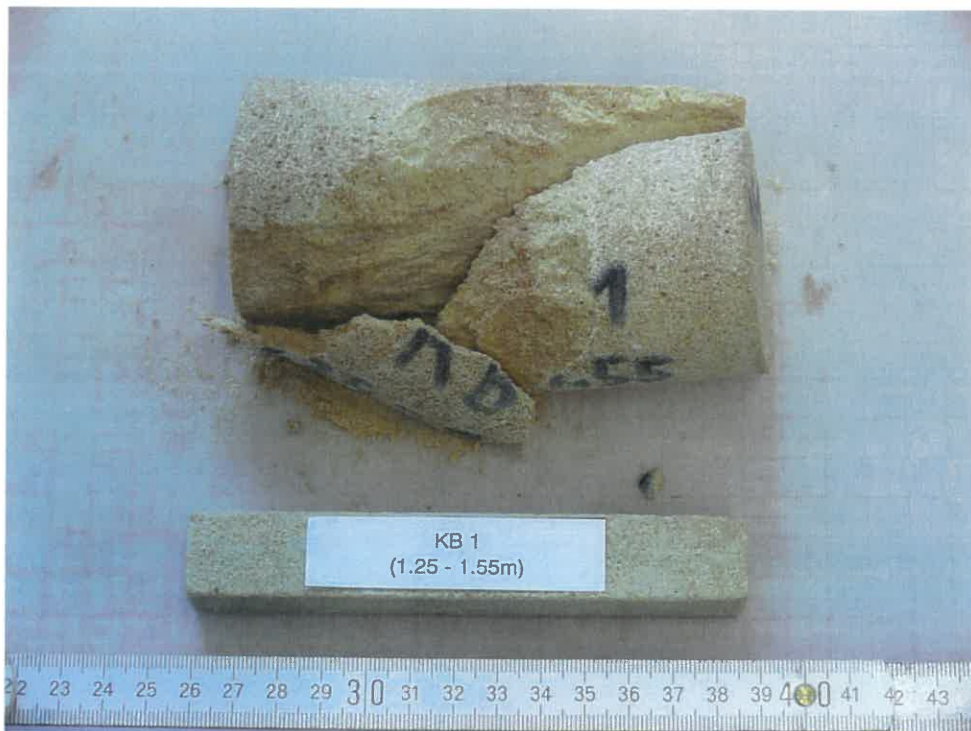
Abbildung 2: KB 1 (1.25 - 1.55m) - NACH Versuch, Bruchbild
