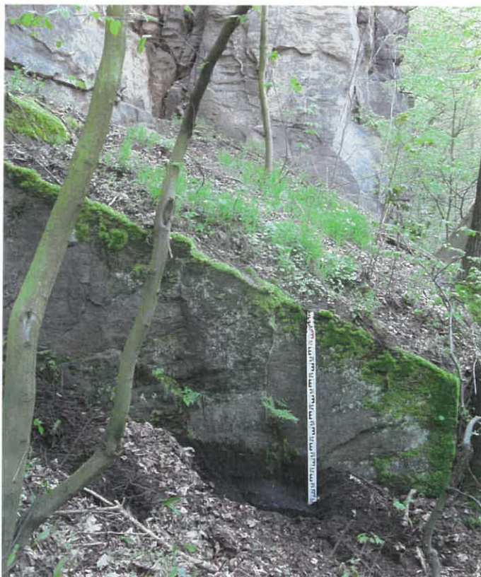
Bild 6: talseitig geneigte Trennfläche und 1,2 m unterhalb im Schurf 2 freigelegte parallel verlaufende Trennfläche
