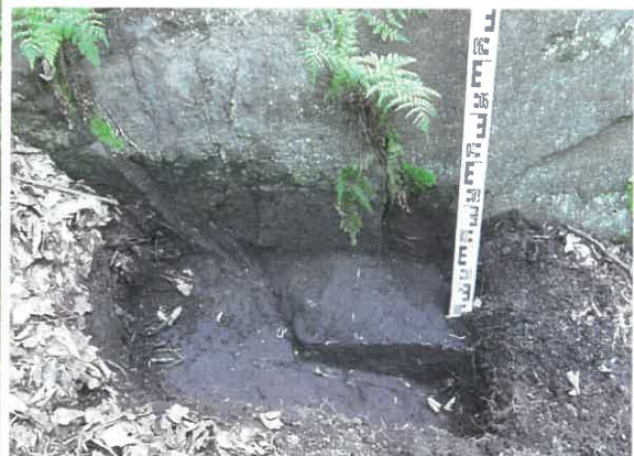
Bild 6: talseitig geneigte Trennfläche und 1,2 m unterhalb im Schurf 2 freigelegte parallel verlaufende Trennfläche
