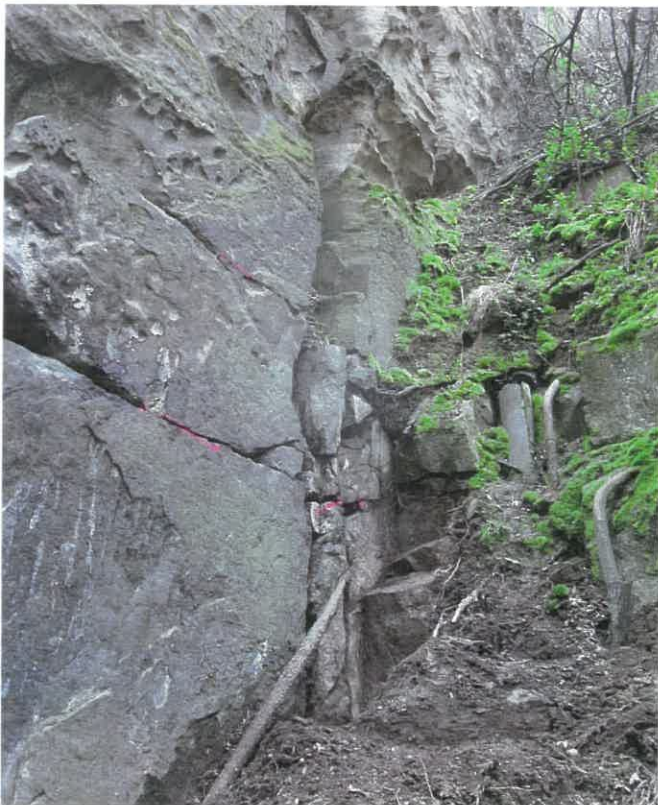
Bilder 11 und 12: Schurf 3 mit talseitig einfallender Trennfläche
